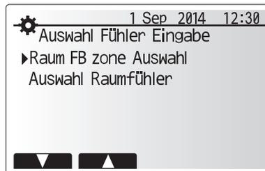
2. Wenn die Temperaturregelung für 2 Heizkreise aktiv ist und Funkfernbedienungen vorhanden sind, wählen Sie im Auswahlwahlfenster „Raum FB Zone“ den Heizkreis (Zone1/Zone2), der den einzelnen Fernbedienungen zugewiesen werden soll.
