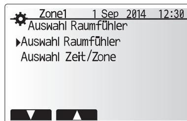
4. Wählen Sie im Fenster für Raumfühlereinstellungen Zeit/Heizkreis, damit verschiedene Raumfühler gemäß der im Menü für die Auswahl von Zeit/Heizkreis eingestellten Zeitsteuerung verwendet werden können. Die Raumfühler können bis viermal innerhalb von 24 Stunden geschaltet werden.
